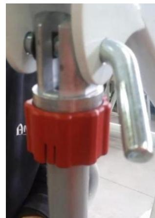
Kada je sigurnosna matica spuštena, zavrtanjem/odvrtanjem matice, moguće je spustiti ili podići ručno dizalicu.
